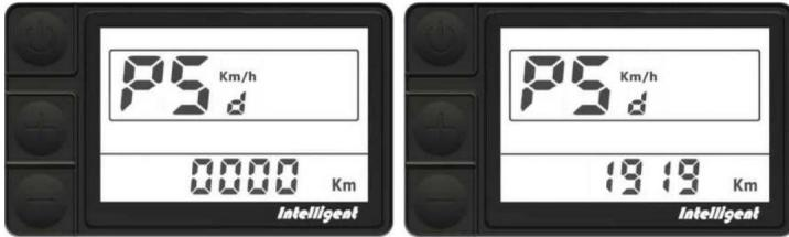
Einstellen der Geschwindigkeitsbegrenzung: Position des SPL-Geschwindigkeitssymbols, Position der Kilometer zeigt den Wert der Geschwindigkeitsbegrenzung an, der Standardwert beträgt 25 km/h. Drücken Sie die UP/DOWN-Taste, um den Wert zu ändern. Der Wert kann zwischen 10 und 45 km/h eingestellt werden. Drücken Sie die POWER-Taste, um zu bestätigen, wenn die Einstellung abgeschlossen ist.
