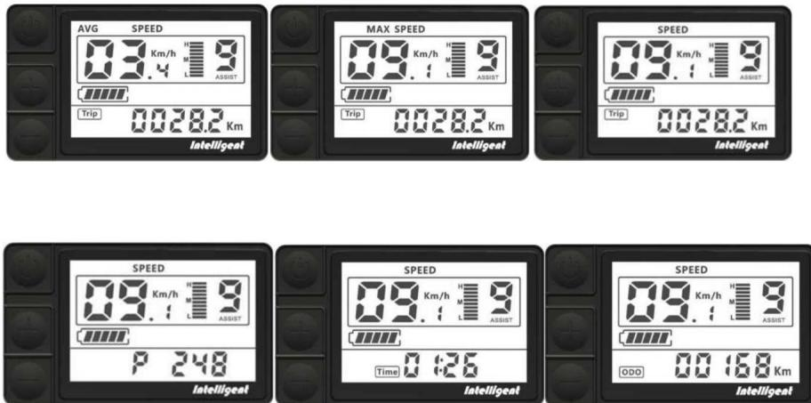
Geschwindigkeitsmoduswähler und Kilometermoduswähler
