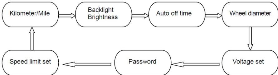
Kilometer/Meile: Die Geschwindigkeitsposition wird durch das Symbol S7 angezeigt, drücken Sie die AUF/AB-Taste. Drehen Sie den Knopf, um das km/h/MPH-Symbol (km/Meile) anzuzeigen.
