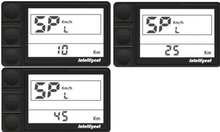
Die Maximaldrehzahl ist durch Motor und Regler begrenzt, der Einstellwert kann vermutlich nicht erreicht werden.
