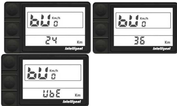
Passwort-/Geschwindigkeitsbegrenzungseinstellung: Die Geschwindigkeitsposition wird durch das PSd-Symbol angezeigt. Sie müssen das Passwort eingeben. Drücken Sie die AUF-/AB-Tasten, um den Passwortwert (0–9) zu ändern. Drücken Sie kurz die POWER-Taste, um die Passwortheingabe umzuschalten. Das Passwort besteht aus vier Ziffern.
