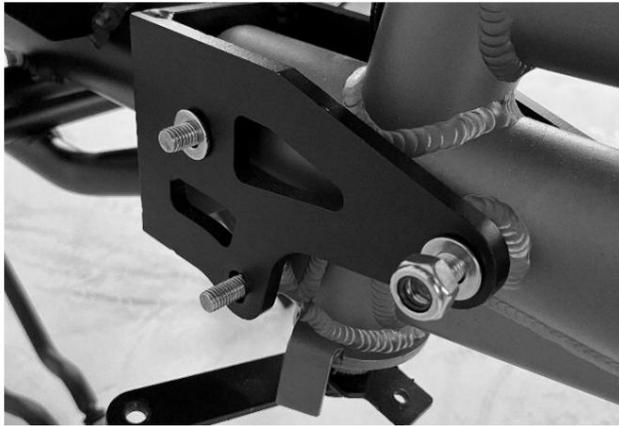
Alle Schraubverbindungen sorgfältig mit einem Mindestanzugsdrehmoment von 25Nm festziehen.
