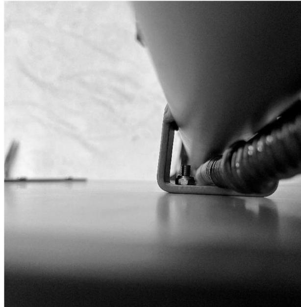
Jede Schraubverbindung zur Befestigung der Cargobox am Fahrradrahmen ist immer mit einer Schraube und einer Mutter mit Unterlegscheibe ausgestattet.
