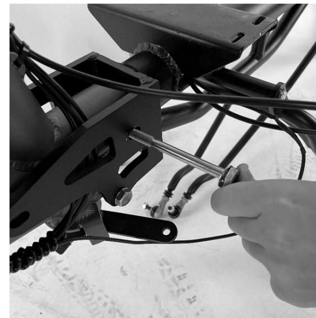
Schieben Sie zuerst eine Unterlegscheibe auf jede Schraube und schrauben Sie dann die Mutter auf.
