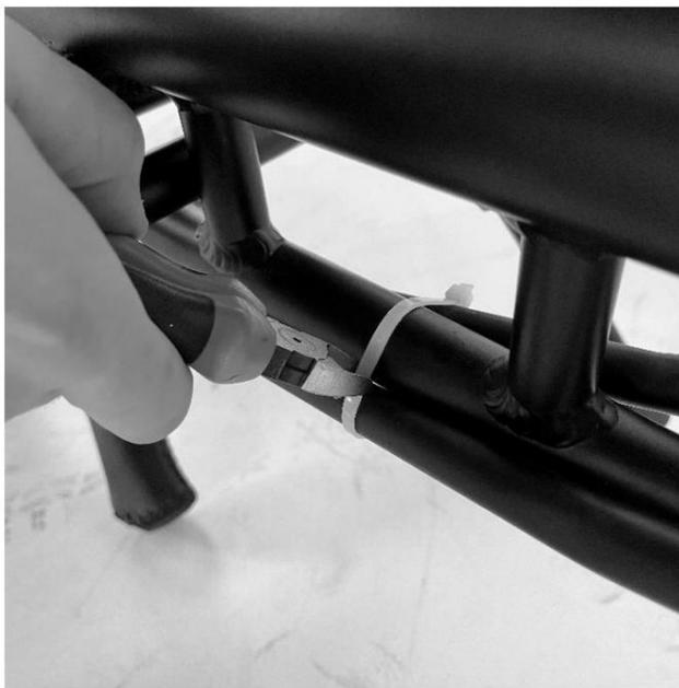
Konzentrieren Sie sich nun auf die Hauptverbindungsstelle zwischen Vorder- und Rückseite des Rahmens. Stellen Sie sicher, dass sich das Rohr- und Kabelbündel, das vom Steuerrohr kommt, unter dem Stahlteil des vorderen Rahmenflansches befindet.
