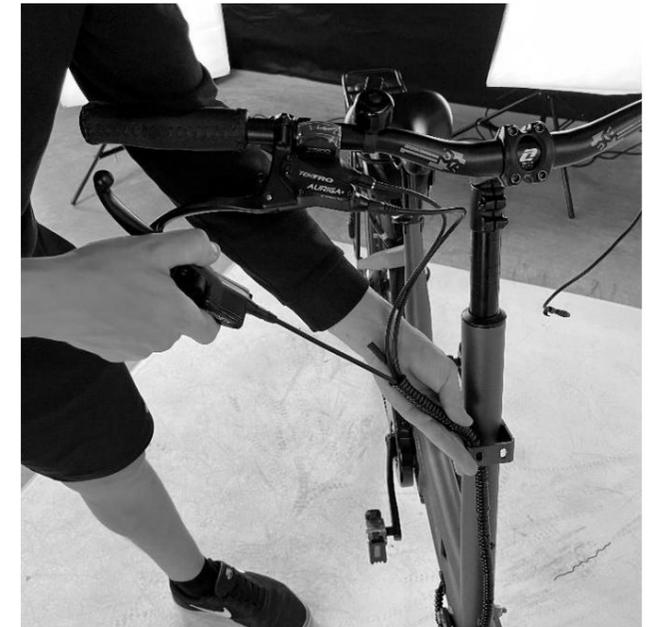
Entfernen Sie den vorderen Teil des Bremssattels der Vorderradbremse. Platzieren Sie den Hebel auf der linken Seite des Lenkers und montieren Sie den vorderen Teil des Bremssattels. Ziehen Sie die Schrauben leicht an und überprüfen Sie dann die korrekte Position des Hebels, der leicht nach unten zeigen sollte. Ziehen Sie nun die Hebeljochschrauben fest an.
