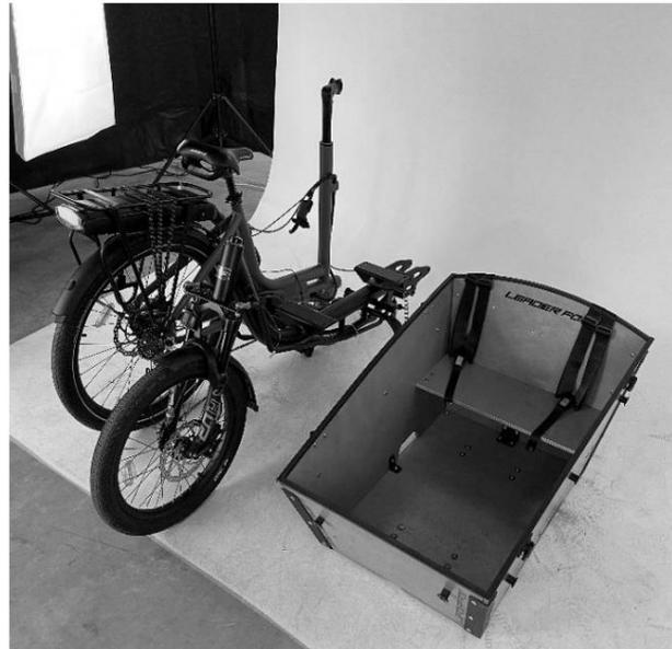
Platzieren Sie die beiden Hauptteile des Rahmens in der im Bild unten gezeigten Montageposition.
