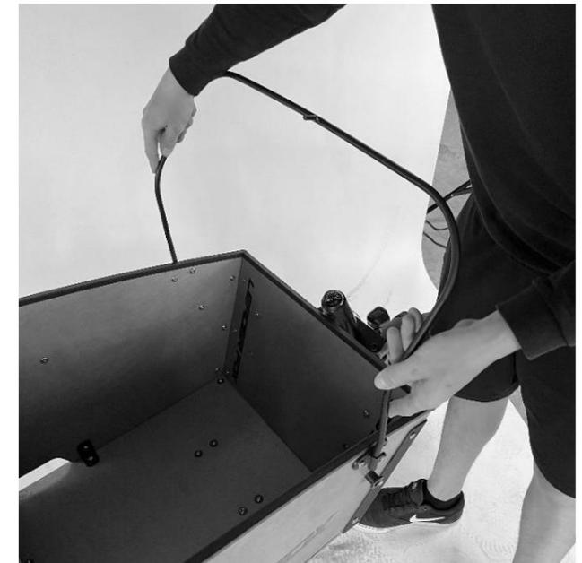
Bild 27 - Sicherung der Segelstruktur
