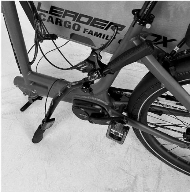
Lösen Sie nach und nach alle Schrauben, mit denen die Dachbox am Rahmen befestigt ist. Bewahren Sie die Schrauben sorgfältig auf, entfernen Sie die Dachbox vom Rahmen und legen Sie sie beiseite.
