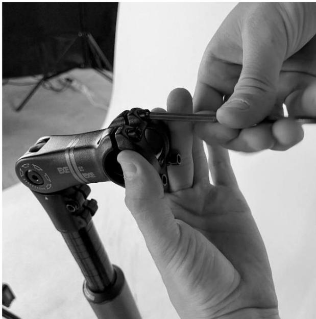
Platzieren Sie den Lenker in der Vorbauaufnahme und zentrieren Sie ihn. Kontrollieren Sie nochmals, dass die Züge und Schläuche nicht verdreht oder geknickt sind und in einem möglichst weiten Bogen zum Rahmen und zur Gabel führen. Setzen Sie die Vorbaublende wieder auf. Ziehen Sie die Klemmschrauben der Blende gleichmäßig über Kreuz an, bis der Lenker leicht festgehalten wird. Bringen Sie den Lenker in die richtige Position, so dass die Bremshebel leicht nach unten zeigen.
