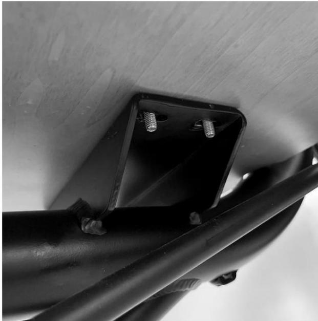
Montieren Sie dann die Frachtbox an der Steuerrohrstruktur.
