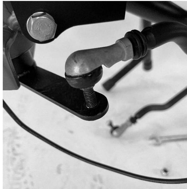
Setzen Sie die Mutter auf die Lenkstangenschrauben und ziehen Sie sie fest.
