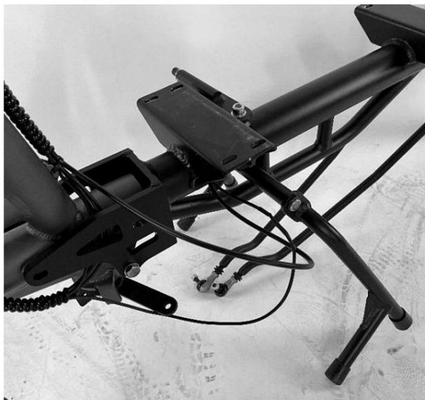
*Bild 11 - Schraubverbindungen sichern die Rahmenverbindung*
