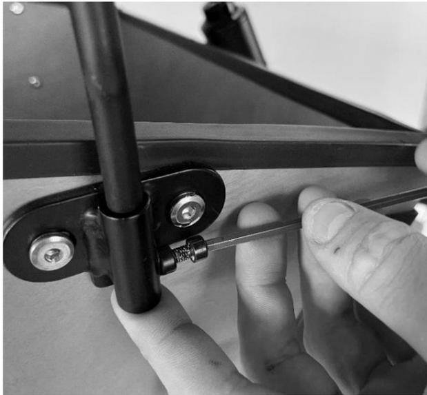
Platzieren Sie dann das horizontale gerade Rohr zwischen den vertikalen Teilen der Struktur.
