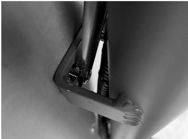
Bild 25 - Cargobox Verschraubungen - Befestigung am Steuerrohr
