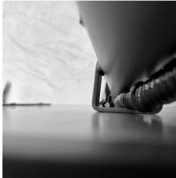
Bild 25 - Cargobox Verschraubungen - Befestigung am Steuerrohr
