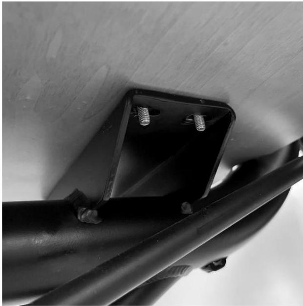
Bild 23 - Verschraubungen Cargobox - Unterseite
