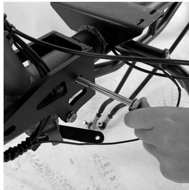
Bild 12 - Schraubverbindungen zur Sicherung der Rahmenverbindung
