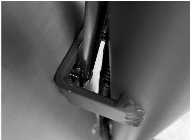
Bild 24 - Cargobox Verschraubungen - Befestigung am Steuerrohr
