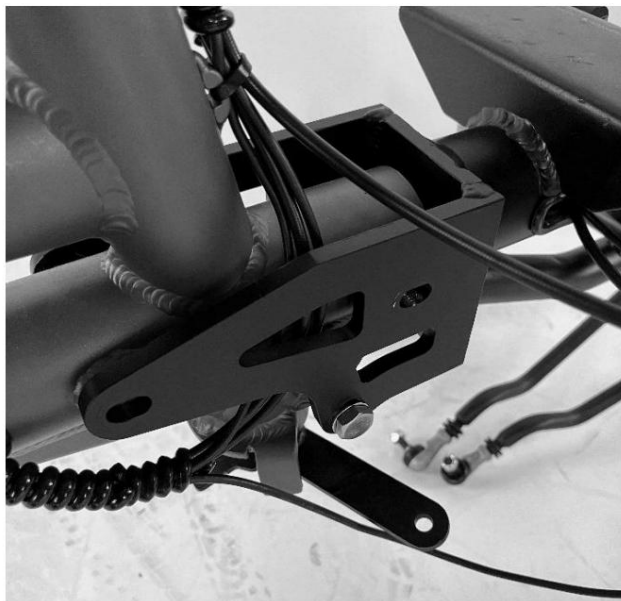
Bild 11 - Schraubverbindungen sichern die Rahmenverbindung
