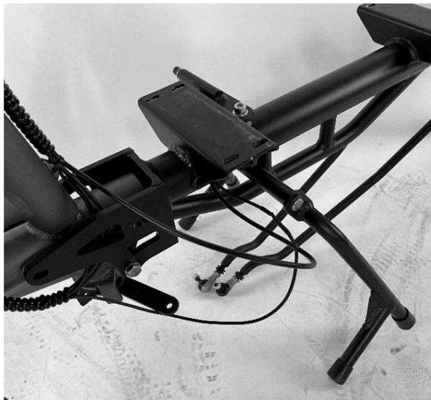
Bild 11 - Schraubverbindungen sichern die Rahmenverbindung
