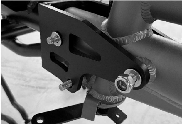
Bild 13 - Anziehen der Schraubverbindungen
