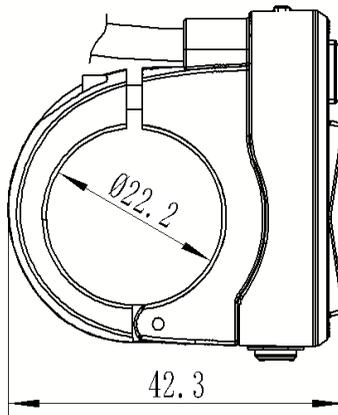
Schlagen Sie die Klemmbacke des Betätigungsschalters auf und platzieren Sie ihn auf der Lenkstange in Ihrer gewählten Position. Ziehen Sie mit einem Inbusschlüssel die Sicherungsschraube M3x8 an.
